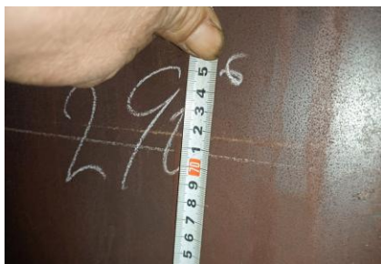
Обечайка: контроль размеров
