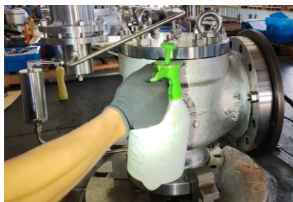
Арматура: проверка герметичности
