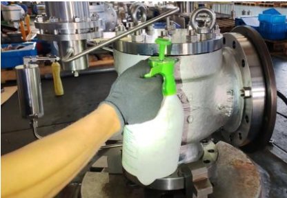
阀门：泄漏试验
