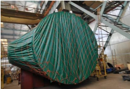
包裹并加网固定待运的塔器
